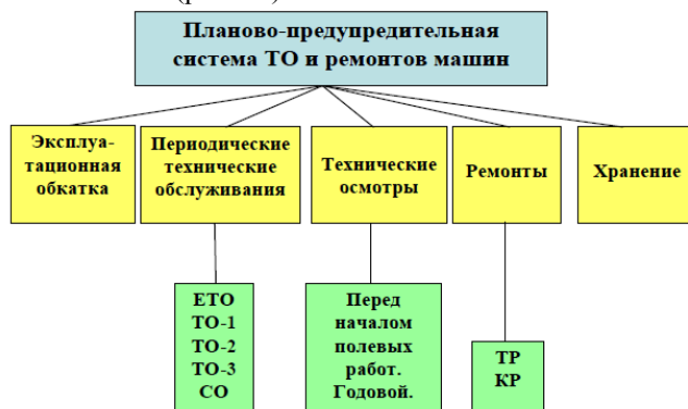
Рис. 14 - Структура планово-предупредительной системы ТО и ремонтов машин
